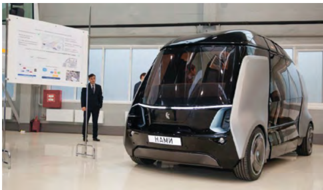
Рисунок 1. Беспилотный автобус «Шатл» вместимостью 10–12 пассажиров для обслуживания специальных маршрутов
