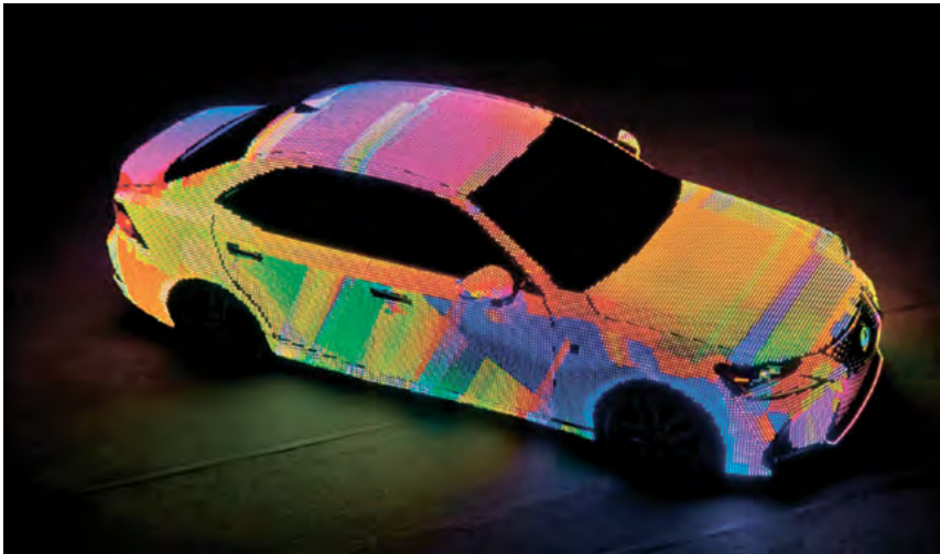
Рисунок 2. В декабре 2016 года компания Lexus представила прототип автомобиля LIT IS, покрытый 41 999 интеллектуальными светодиодами, которые превращают корпус автомобиля в интерактивный светодиодный экран, способный отображать динамическую графику и видео
