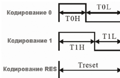
Рисунок 5. Принцип побитной передачи данных, используемый интеллектуальными светодиодами
