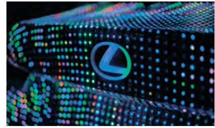
Рисунок 2. В декабре 2016 года компания Lexus представила прототип автомобиля LIT IS, покрытый 41 999 интеллектуальными светодиодами, которые превращают корпус автомобиля в интерактивный светодиодный экран, способный отображать динамическую графику и видео
