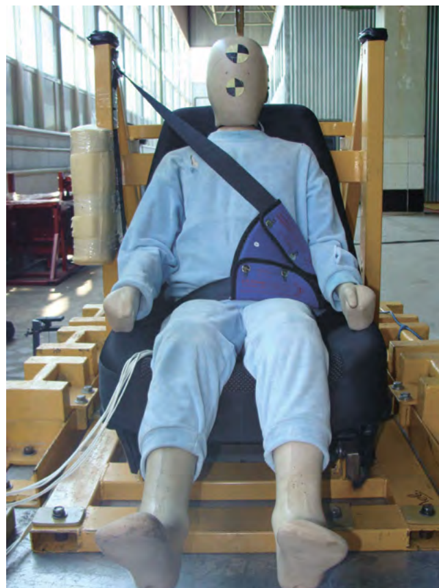
Рисунок 5а. Состояние ДУУ «ФЭСТ» с манекеном P10 и формовочной глины до фронтального столкновения
