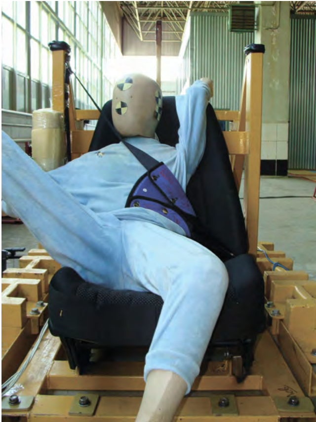
Рисунок 5б. Состояние ДУУ «ФЭСТ» с манекеном Р10 и формовочной глины после фронтального столкновения (на скорости 50 км/ч)
