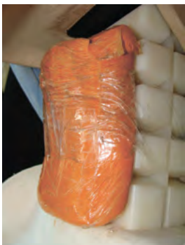
Рисунок 5б. Состояние ДУУ «ФЭСТ» с манекеном Р10 и формовочной глины после фронтального столкновения (на скорости 50 км/ч)
