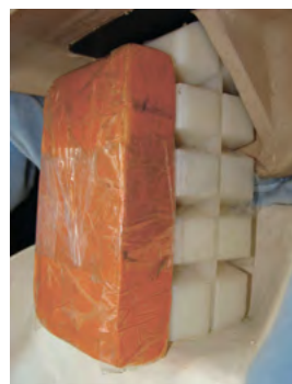
Рисунок 5а. Состояние ДУУ «ФЭСТ» с манекеном P10 и формовочной глины до фронтального столкновения
