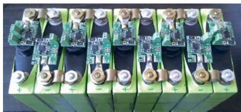
Рисунок 3. Размещение Slave-контроллеров распределённой BMS на аккумуляторных ячейках с винтовым соединением
