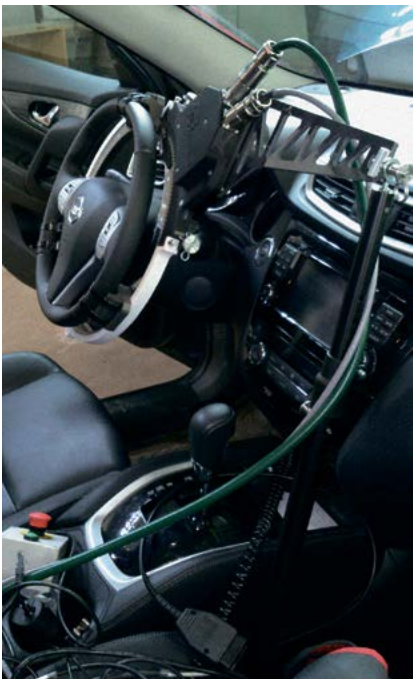
Рисунок 3. Рулевой робот Steering Robot AB Dynamics Orbit
