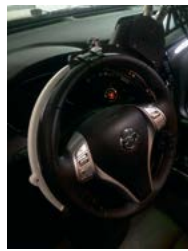
Рисунок 3. Рулевой робот Steering Robot AB Dynamics Orbit
