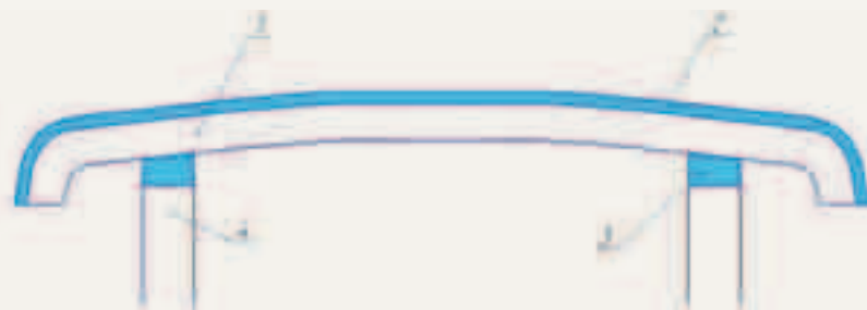
Рисунок 2. Принципиальная схема бампера с эластомером: 1 — жёсткий бамперный брус; 2 — покрытие изменяемой жёсткости из магнитоэластомера; 3 — магнитоэластомерная вставка-крепление изменяемой жёсткости; 4 — лонжерон рамы автомобиля, к которому крепится бампер
