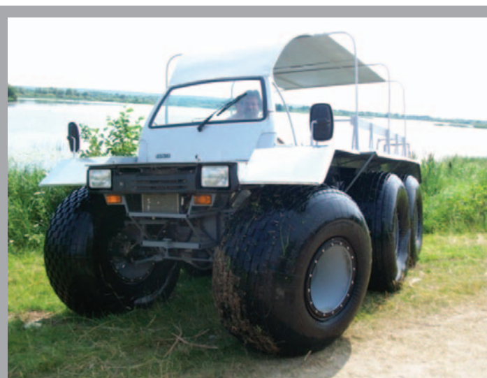
Рисунок 3. Исследуемое вездеходное транспортное средство 6x6
