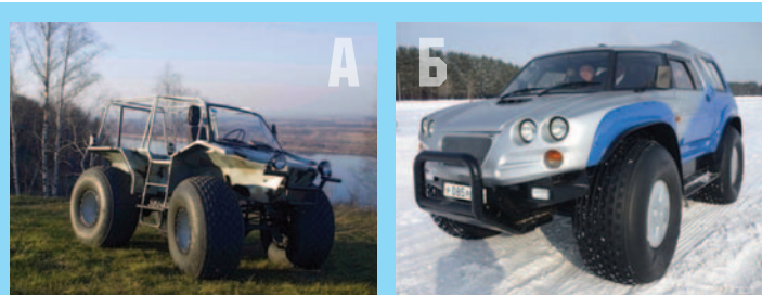
Рисунок 1. ТС на шинах сверхнизкого давления: а) «Тритон» 4x4 (ООО «НИРФИ»); б) «Викинг» 4x4 (ООО «Атон-Импульс», ГК «КОМ»)
