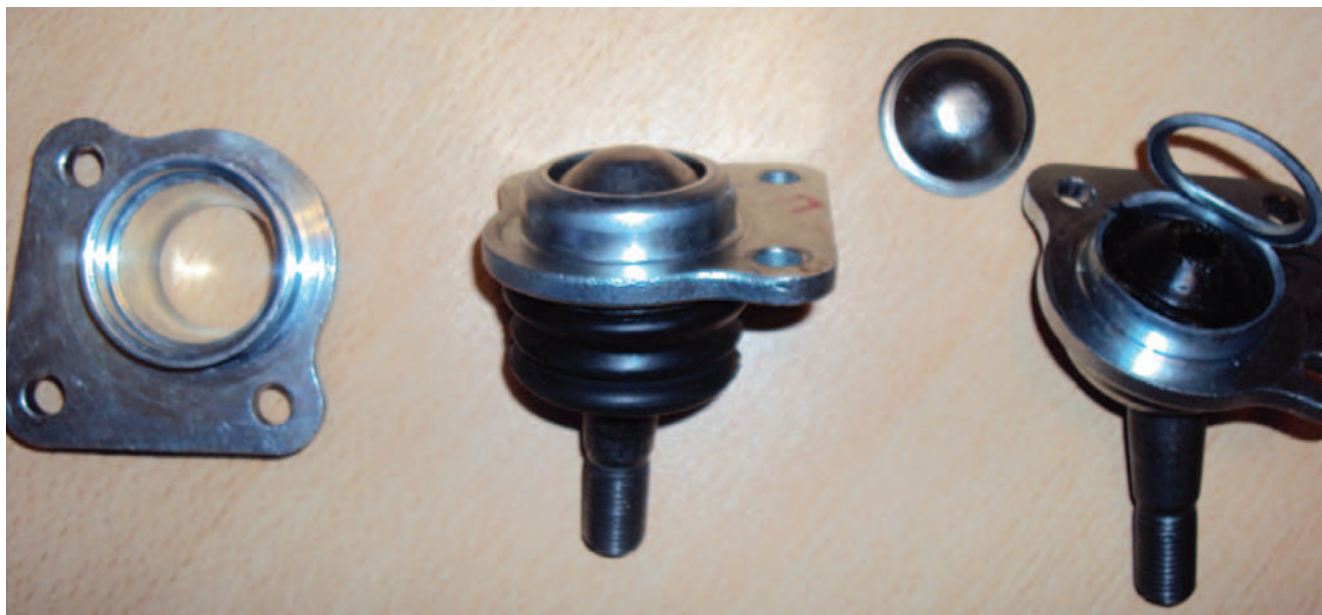
Рисунок 4. Внешний вид корпуса до запрессовки, изделия после запрессовки и после испытания на выдавливание шарового пальца из корпуса
