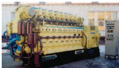
Рисунок 1. Комбинированный поршневой дизельный двигатель 8ЧН 22/28
