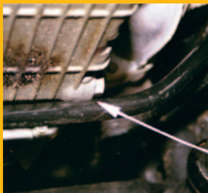
Рисунок 4. Контакт торсиона стабилизатора поперечной устойчивости с картером двигателя
