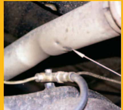
Рисунок 3. Контакт тройника тормозных трубок с выпускной трубой глушителя и картером моста
