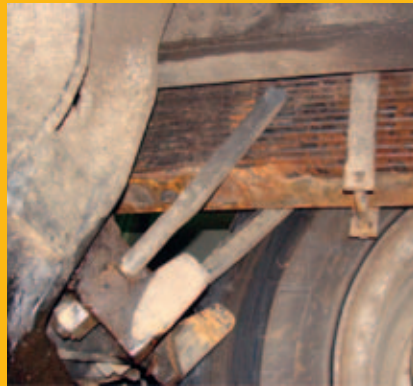
Рисунок 2. Обрыв стремянок задней рессоры
