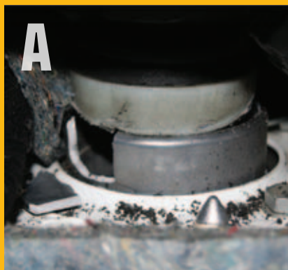
Рисунок 5 (а, б). Разрушение элементов крепления верхней опоры передних амортизаторов
