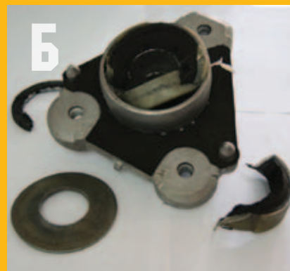
Рисунок 5 (а, б). Разрушение элементов крепления верхней опоры передних амортизаторов
