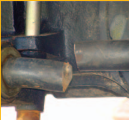
Рисунок 1. Поломка торсиона стабилизатора поперечной устойчивости
