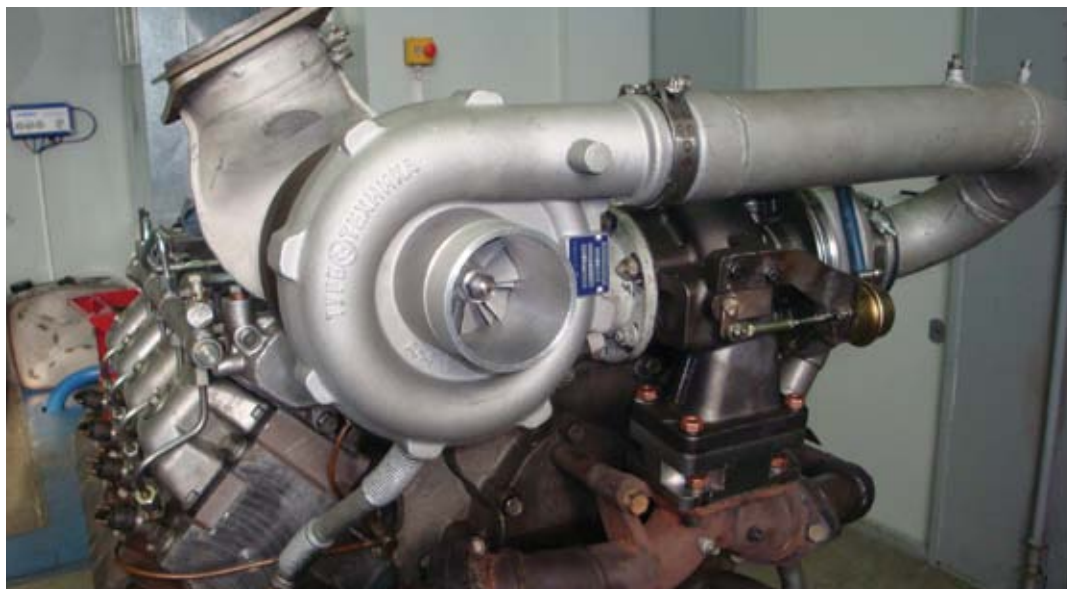
Рисунок 15. Компоновка системы 2-х ступенчатого наддува двигателя КамАЗ-740.75-440 (прототип EURO-5)
