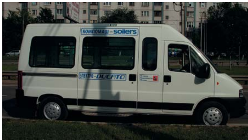
Рисунок 3. Электробус на шасси модели Ducato
