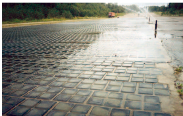
Рисунок 8. Испытательный участок с увлажняемым базальтовым покрытием
