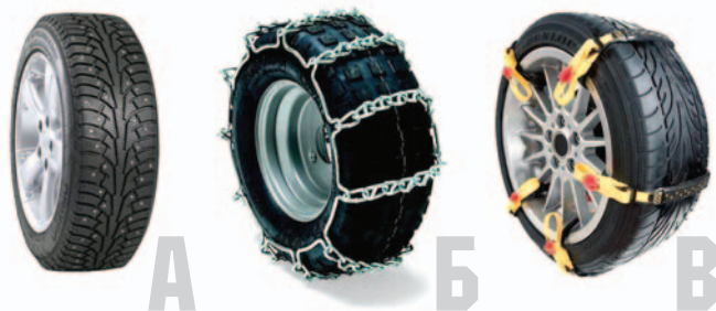
Рисунок 1. Средства противоскольжения: а — шипованная шина; б — цепи противоскольжения; в — ремни противоскольжения
