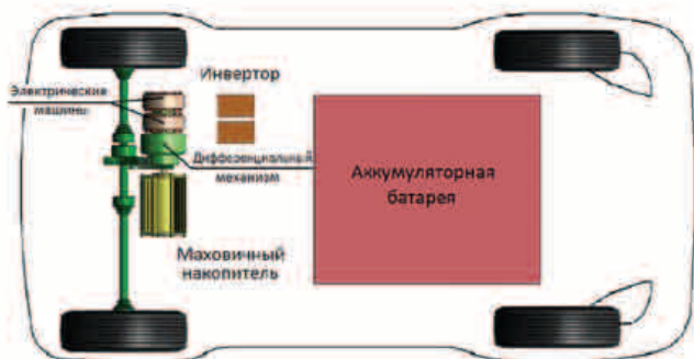
Рисунок 1. Схема электромобиля с комбинированным тяговым приводом с маховичным накопителем энергии
