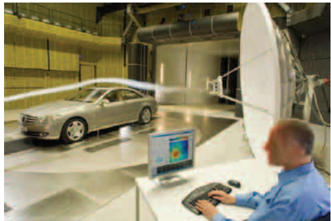
Рисунок 1. Акустическое зеркало с микрофонами при испытании в акустической трубе
