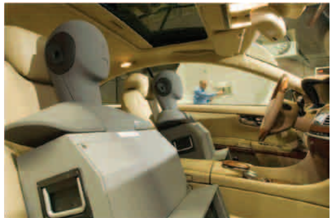
Рисунок 2. Акустические манекены для определения шумового воздействия на уши водителя и пассажиров
