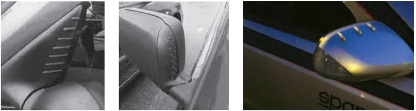
Рисунок 4. Генераторы турбулентного потока на боковых зеркалах заднего вида
