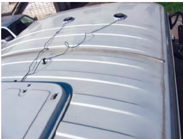
Рисунок 10. Схема установки антенн на крыше автобуса
