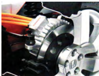
Рисунок 3. Электродвигатель (25 кВт) привода колеса задней оси авто- мобиля Honda FCX Concept
