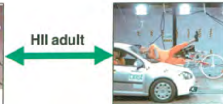
Рисунок 5. Расположение манекенов относительно линий WAD при испытаниях
