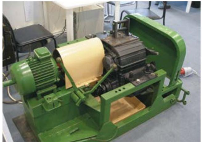
Рисунок 1. Стенд для испытания РК
