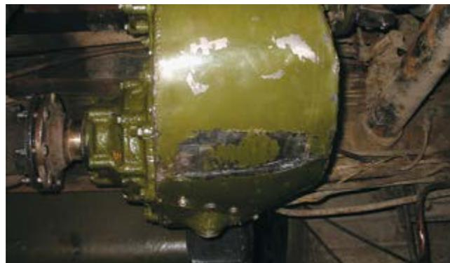
Рисунок 5. Установка новой РК на автомобиль
