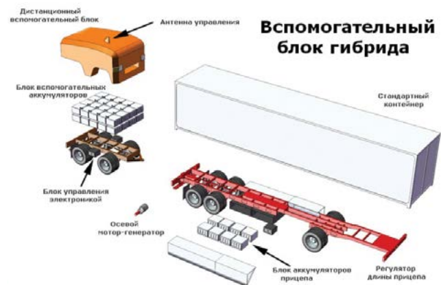
Рисунок 2. Принципиальная компоновочная схема гибридного автопоезда с дополнительным модулем
