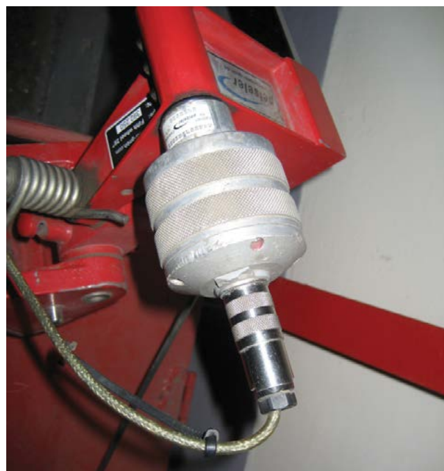
Рисунок 4. Измерительная система для проведения испытаний на ускорение и торможение транспортных средств DB-PRINT: а) блок обработки и отображения информации; б) «пятое колесо»; в) импульсный датчик
