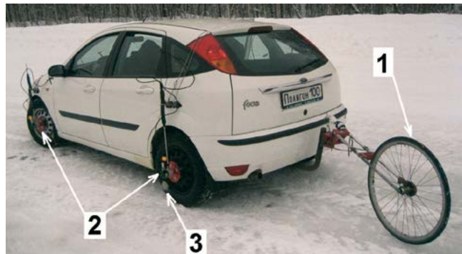
Рисунок 2. Автомобиль — шинный тестер: 1 — система DB-PRINT типа «пятое колесо»; 2 — выносной датчик угловой скорости колеса; 3 — контрольная метка
