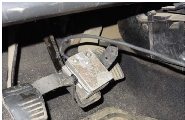
Рисунок 6. Датчик усилия нажатия на педаль тормоза (а) с блоком питания и индикации (б)
