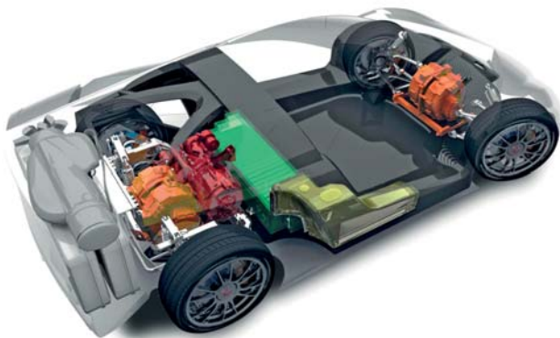
Рисунок 4. Размещение силовых агрегатов на полноприводном электромобиле
