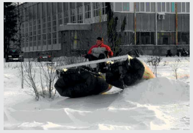
Рисунок 4. Экспериментальная тележка НИЦИАМТ образца 2004 года на торовых движителях [7]
