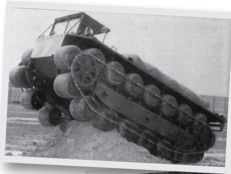
Рисунок 1. «Аэрол» — вездеход XM-759. США, 1965 год
