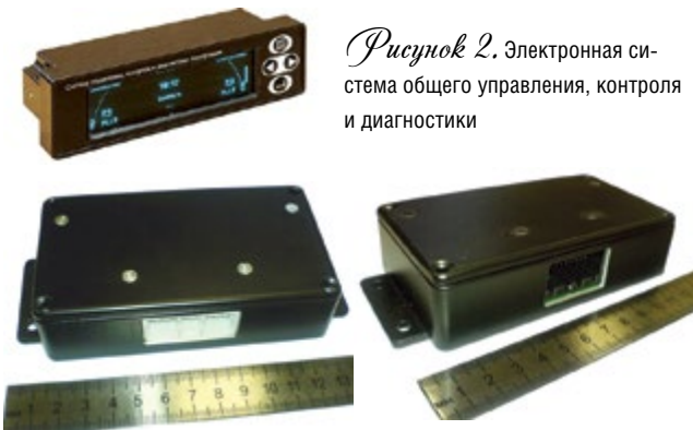
Рисунок 3. Бортсеть нового поколения: а — блок органов управления; б — унифицированный функциональный контроллер; в — дисплей
