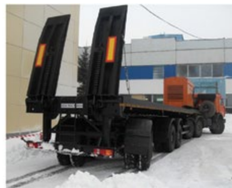
Рисунок 1. Перспективные многозвенные автопоезда с активными прицепными звеньями: а — опытный образец многозвенного магистрального автопоезда с активными прицепными звеньями (разработчик — ОИМ НАН Республики Беларусь и ОАО «МАЗ»); б — опытный образец активного автопоезда с автономным гидрообъемным приводом колёс полуприцепа (разработчики — ОАО «НАМИ-Сервис» и Камский завод «Трансмаш»)
