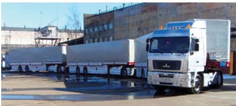
Рисунок 1. Перспективные многозвенные автопоезда с активными прицепными звеньями: а — опытный образец многозвенного магистрального автопоезда с активными прицепными звеньями (разработчик — ОИМ НАН Республики Беларусь и ОАО «МАЗ»); б — опытный образец активного автопоезда с автономным гидрообъемным приводом колёс полуприцепа (разработчики — ОАО «НАМИ-Сервис» и Камский завод «Трансмаш»)
