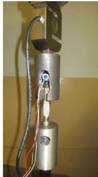
Рисунок 5. Фрагмент тарировки тензометрического болта
