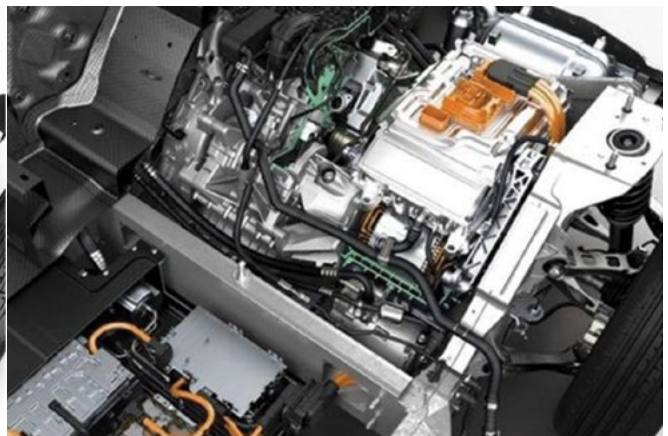
Рисунок 13. Компонировка моторного отсека: а) без системы Range Extender; б) с блоком «ДВС — генератор» системы Range Extender
