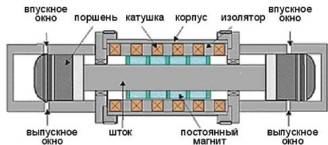
Рисунок 6. Система Range Extender на основе свободнопоршневого двигателя с линейным генератором
