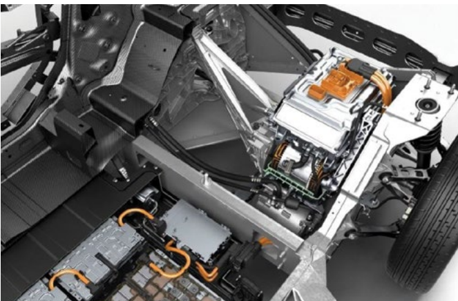
Рисунок 13. Компонировка моторного отсека: а) без системы Range Extender; б) с блоком «ДВС — генератор» системы Range Extender
