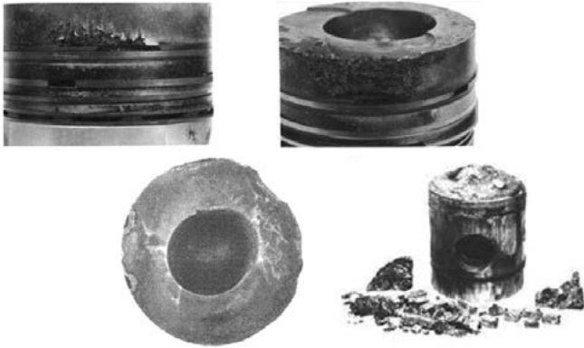
Рисунок 8. Оплавление головки поршня и его поверхностей
