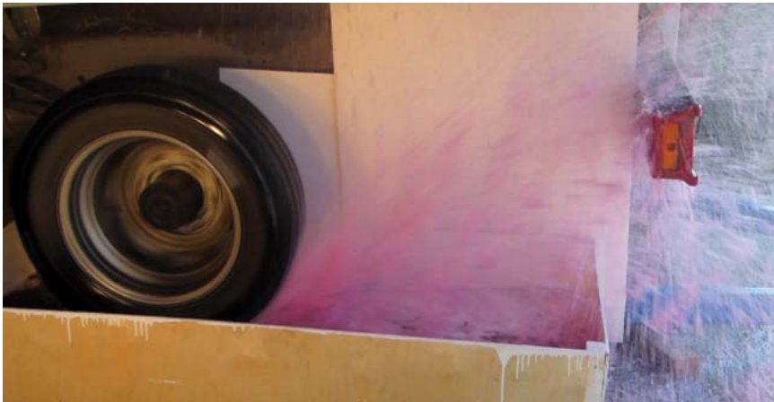
Рисунок 5. Эксперимент по определению угла потока частиц из-под колеса
