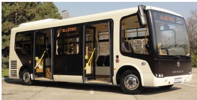
Рисунок 5. Электрический автобус Evopro Modulux с несущей системой из стеклопластика
