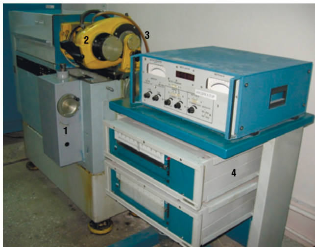
Рисунок 1. Машина трения модели ИИ-5018: 1 — испытательная установка; 2 — испытательная камера; 3 — соединительные устройства; 4 — приборная стойка
