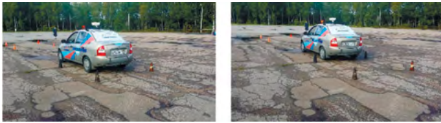
Рисунок 11. Кадры положений БАС на базе серийного автомобиля LADA Kalina при выполнении манёвра «переставка S_{II} = 20 м»
