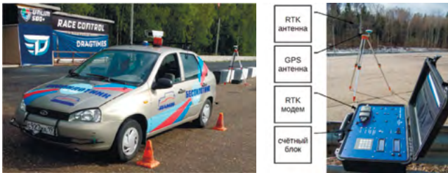
Рисунок 10. Внешний вид БАС на базе LADA Kalina с подключённой системой ADMA-G и развёрнутой базовой станцией
