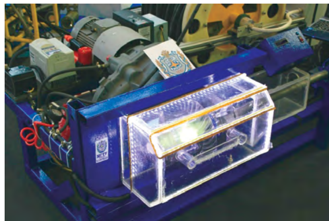
Рисунок 7. Стенд испытания алгоритма включения кулачковой муфты блокировки межколёсного дифференциала
