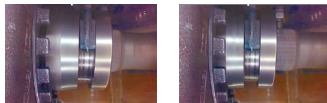
Рисунок 8. Кулачковая муфта блокировки межколёсного дифференциала: а — выключенное положение; б — включённое положение
